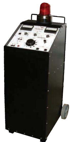
HPA-055M 5 kV @ 5 kVA 电机企业型号 (C1控制器) 带烧穿模式
