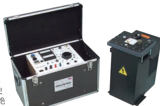
VLF-6022CM 0-60kVac (峰值) @ 0.1 – 0.02 Hz 额定负载5.5uF
